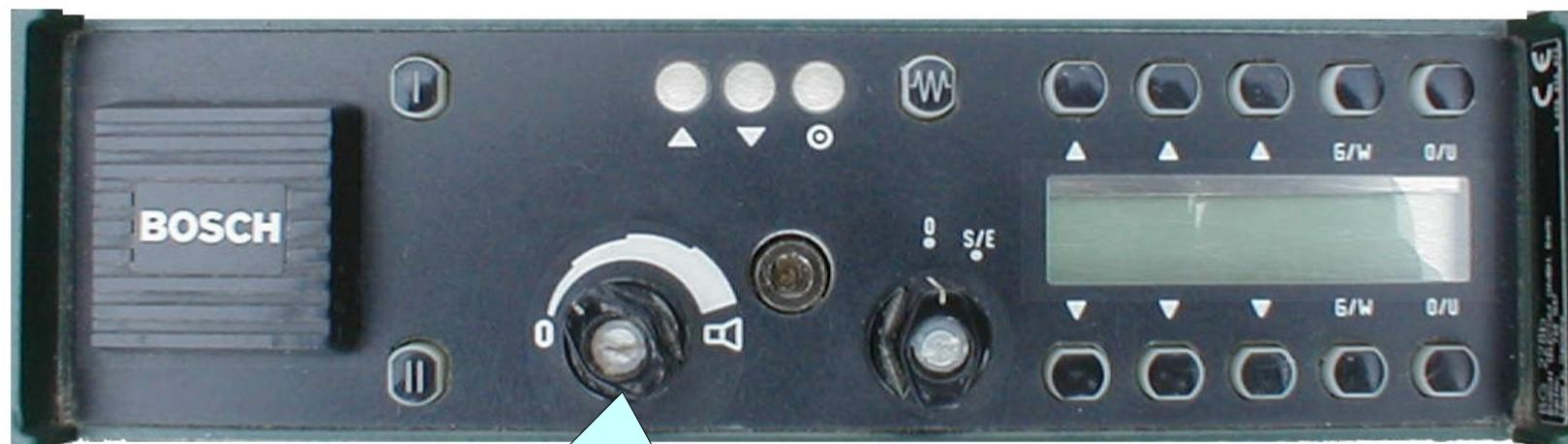
**Beendet sich nur ein Mikrophon am Funkgerät, ist in der Stellung 0 der Funkverkehr nicht zu hören!!**
