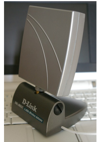
Indoor-Richtantenne mit einem Versorgungswinkel von ca. 80 Grad
