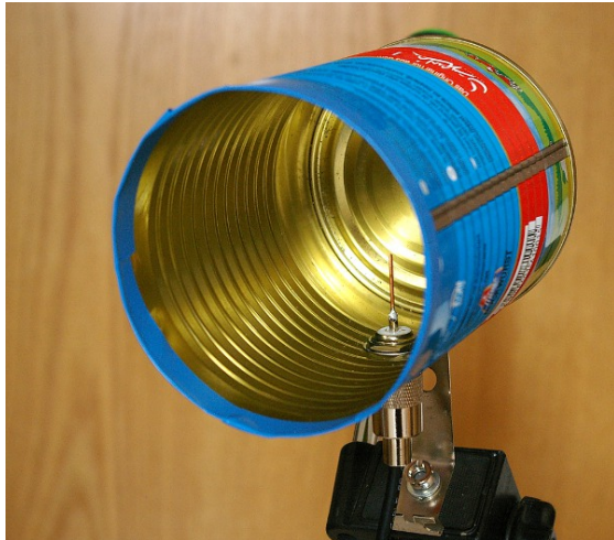
Cantenna: Abstrahlwinkel etwa 60 Grad Gewinn zwischen 10 und 14 dB
