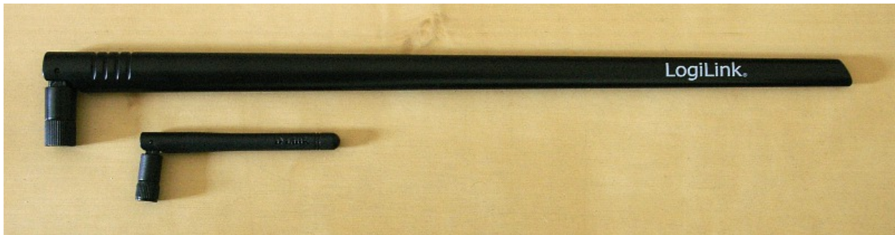
Rundstrahler: unten: Standardantenne eines Routers oben: Rundstrahler mit Gewinn
