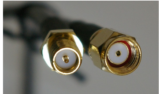
RP- SMA: links: Buchse rechts: Stecker
